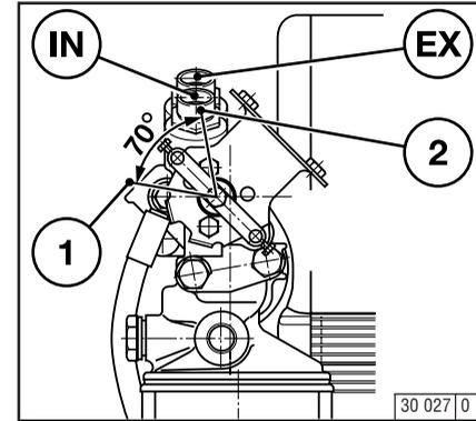
Положение переключателя в случае консоли масляного фильтра с присоединительным элементом для обогрева масла:
