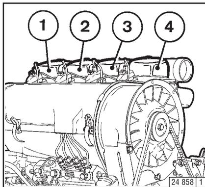
Цилиндры пронумерованы последовательно, начиная со стороны маховика.
