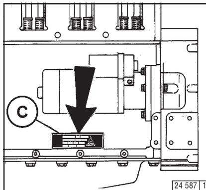
Фирменная табличка **C** закреплена на картере; в зависимости от исполнения, возможно, предусмотрена вторая фирменная табличка на кожухе воздуховода.
