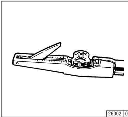
Инструмент для измерения натяжения клинового ремня можно заказать под номером для заказов 8115 у фирмы:
