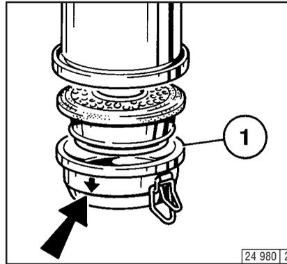
Наполнить масляную ёмкость 1 инерционно-масляного воздушного фильтра моторным маслом до маркировочной стрелки.
