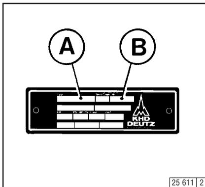
Тип **A**, номер двигателя **B**, а также рабочие характеристики выбиты на фирменной табличке. При приобретении запасных частей необходимо указать тип и номер двигателя.
