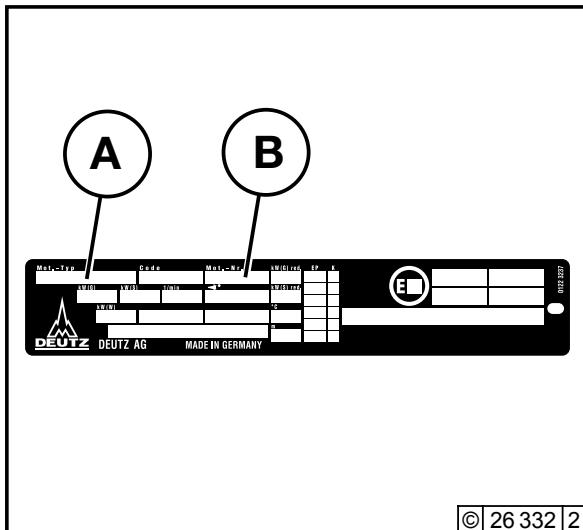
Модель **А**, номер двигателя **В**, а также технические данные выбиты на фирменной табличке.
