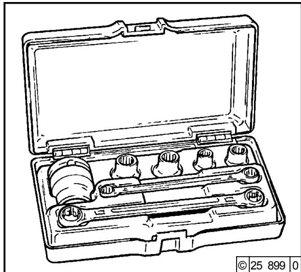
На двигателях серии 2011 используется также система винтов TORX **BN. 8189** для применения.
