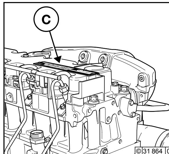
Фирменная табличка **С** закреплена на крышке клапанного блока.
