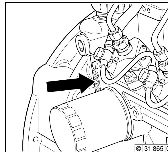
Номер двигателя **В** выбит на картере **Д** и на фирменной табличке.
