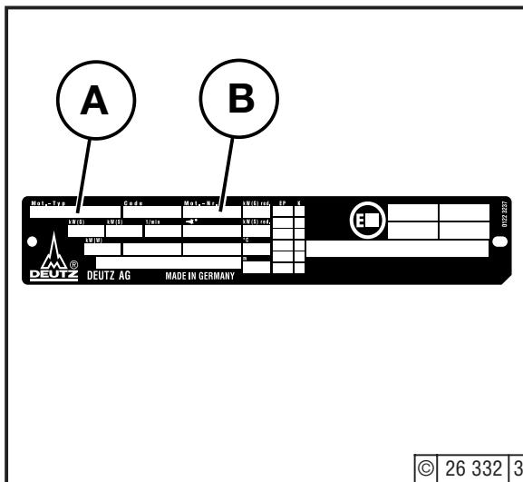
Η κατασκευαστική παραλλαγή **A**, ο αριθμός του κινητήρα **B** καθώς επίσης και τα τεχνικά στοιχεία ισχύος του κινητήρα έχουν σφραγιστεί επάνω στην πινακίδα του εργοστασίου κατασκευής. Κατά την παραγγελία ανταλλακτικών πρέπει να γίνεται αναφορά της κατασκευαστικής παραλλαγής και του αριθμού του κινητήρα.
