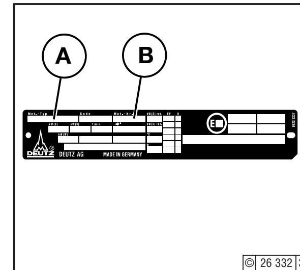
**A** يكون كل من النمط التصميمي للمحرك ورقم المحرك **B** ، وكذلك بيانات قدرة المحرك ، مدموعة على لوحة الطرز زللحرك. ويتحتم ذكر النمط التصميمي للمحرك وكذلك رقم المحرك لدى كل طلب توريد لقطع غيار المحرك .
