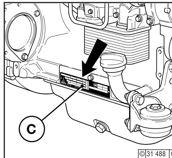
La plaque du constructeur **C** est fixée sur le bloc moteur.
