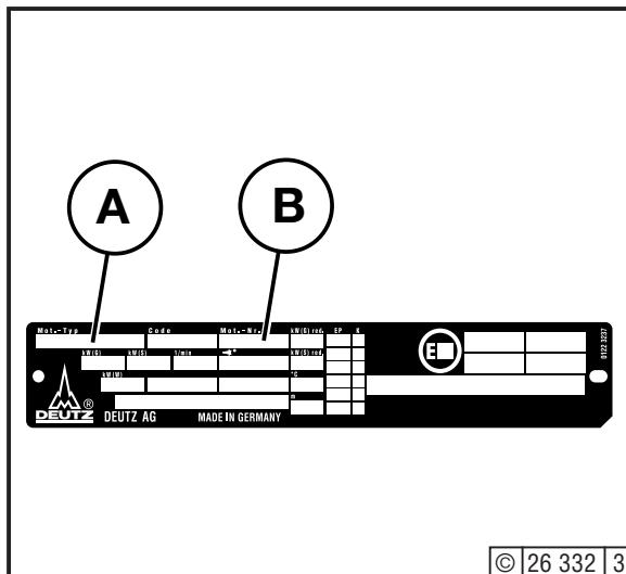
Die Bauart **A**, die Motornummer **B** sowie die Leistungsdaten sind auf dem Firmenschild eingestempelt.
