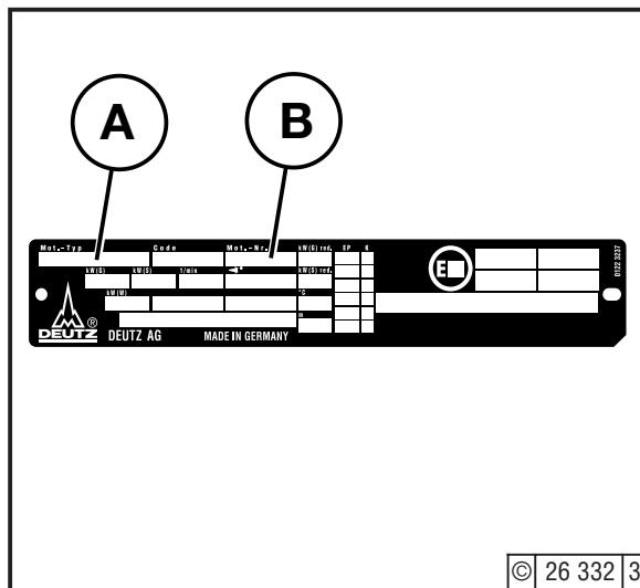
De constructievorm **A**, het motornummer **B** en de vermogensgegevens zijn op de firmaplaat gestempeld. Bij bestelling van onderdelen moeten constructieserie en motornummer worden aangegeven.
