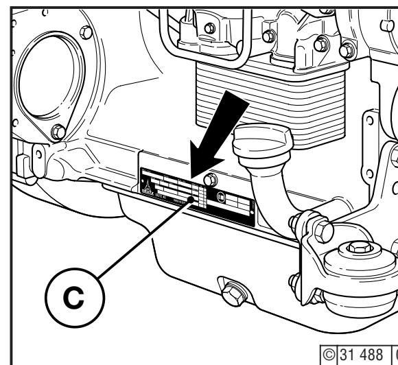
A placa do fabricante **C** encontra-se fixada ao cárter.
