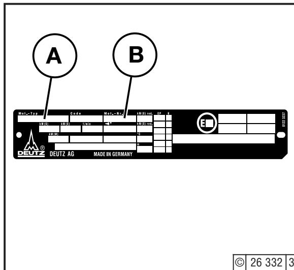
Il tipo di costruzione **A**, il numero del motore **B** ed i dati tecnici sono stampigliati sulla targhetta di fabbricazione. Per l'acquisto di pezzi di ricambio, bisogna indicare il tipo di costruzione ed il numero del motore.
