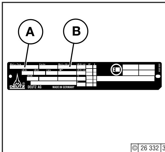
Typen **A**, motornumret **B** och motordata finns på typskylten. Vid reservdelsbeställning måste typ och motornummer anges.
