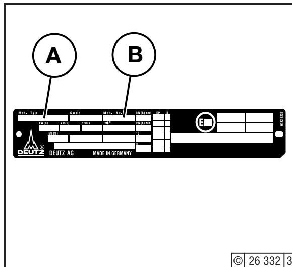
Typ **A**, numer silnika **B**, jak i dane odnośnie mocy zostały odcisknięte na tabliczce firmowej.
