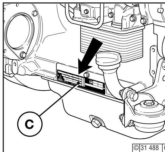
Η πινακίδα του εργοστασίου κατασκευής **C** βρίσκεται στερεωμένη επάνω στο κίβωτο του στροφάλου.
